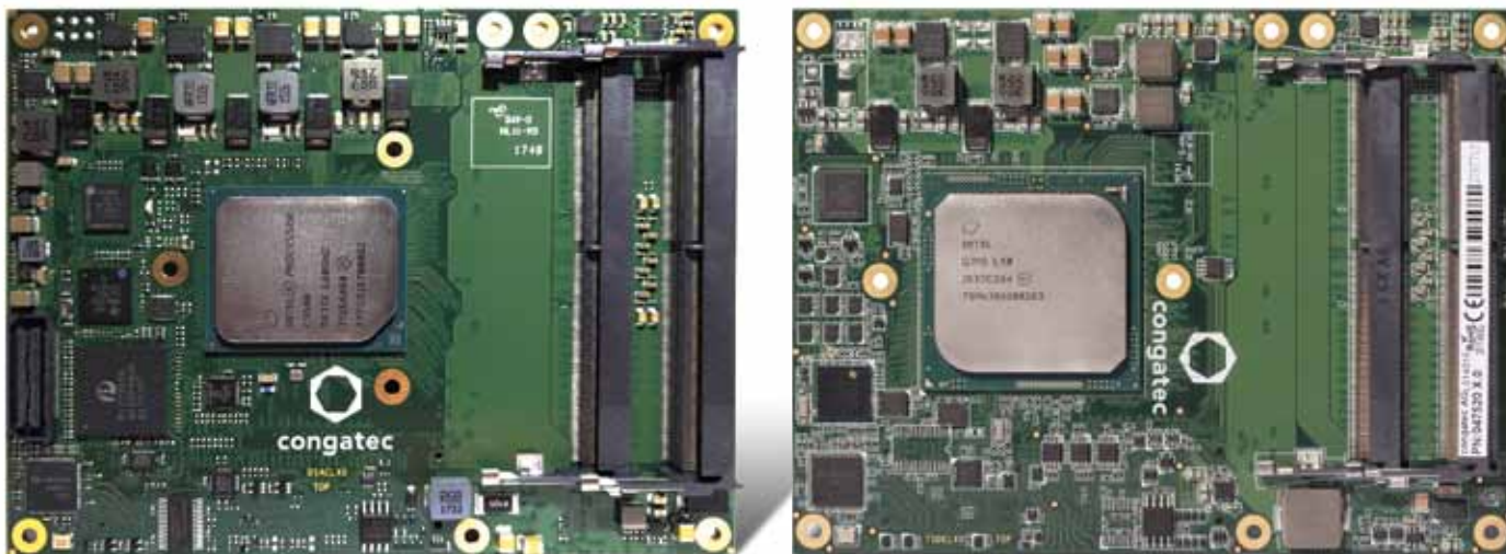
Conga-B7AC och Conga-B7XD är servermoduler av typen COM Express Type 7 i Basicformat med Intel Atom, Intel Pentium D eller Intel Xeon.
