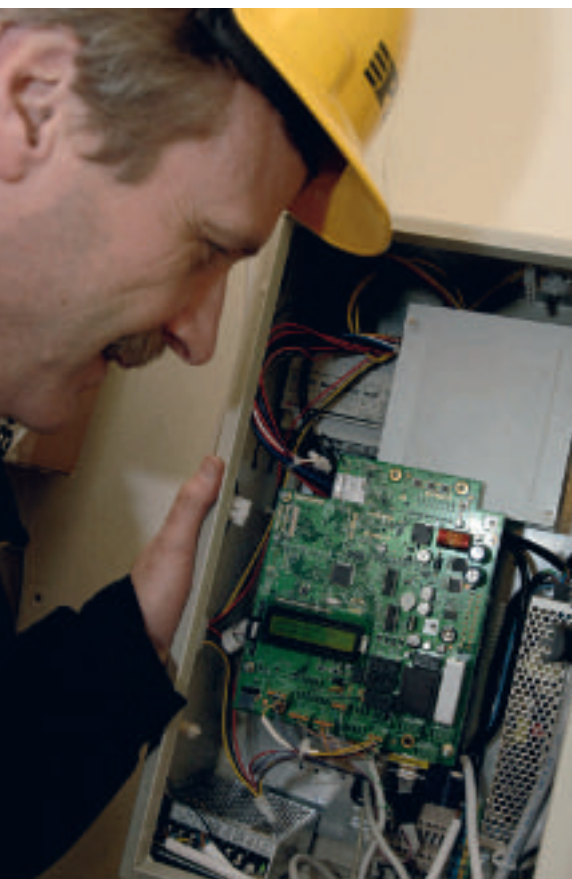
Elektroniken styr inte bara låset och verktygen. Här finns även brandlarm och förstärkt kommunikation med omvärlden via Internet.
