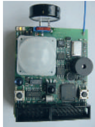
Framtidens sensornoder ska vara små som mynt, eller som riskorn i de vildaste visionerna. Sensornoden som Saab använde har GoldCapkondensator, PIR-sensor, radiomodul, sumner, mikrofon, vibrationssensor och MSP430-processor.
