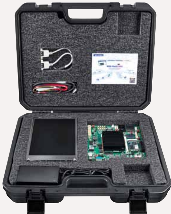
Strömsnäla Smarc 2.0 använder NXP:s Armprocessorer, eller som här Intel Atom.
