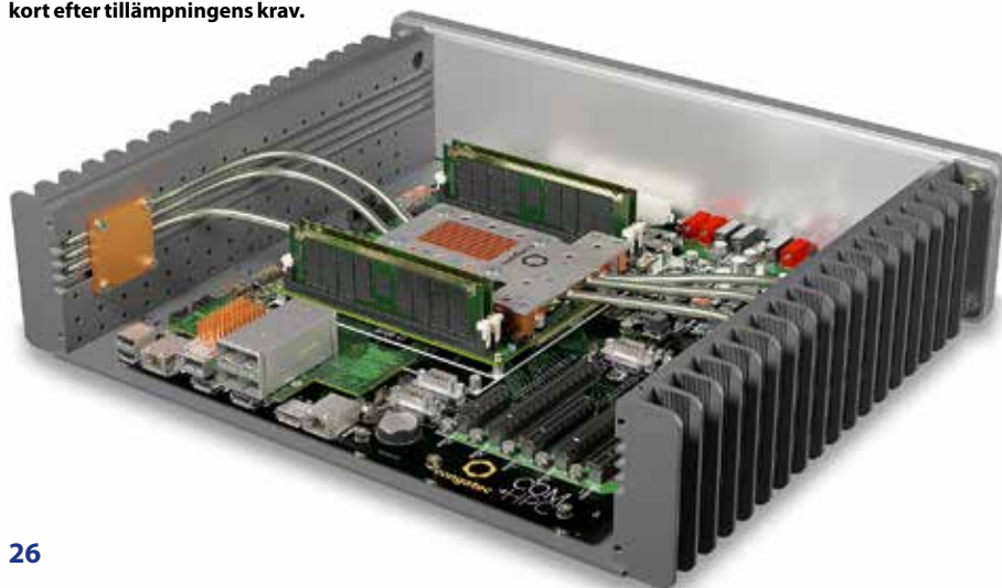
Bild 1. Congatecs AI-plattform passar för CT- och MR-apparater, liksom för andra edge AI-tillämpningar som kräver kombinationen av hög tillförlitlighet och fläktlös drift. Du kan flexibelt välja AI-accelerator-kort efter tillämpningens krav.
