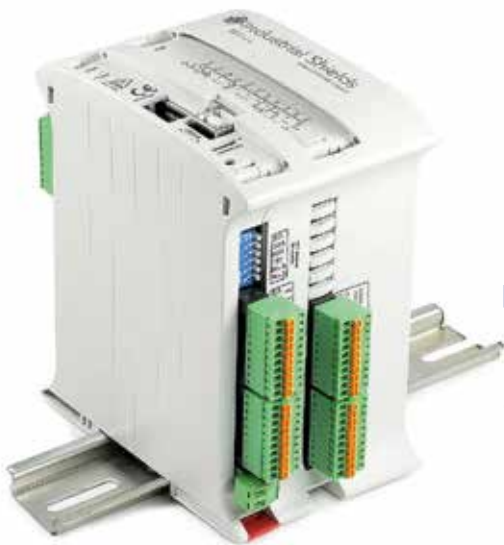
Modellen IS.MDUINO.21+ från Industrial Shields har 13 ingångar och 8 utgångar.
