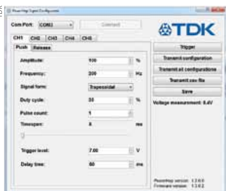
Figur 6. Programvaran för TDK PowerHap-utvärderingssatsen erbjuder ett signalkonfigurationsgränssnitt. När konfigurationen har ställts in kan den skickas till utvärderingskortets processor via knappen "Transmit configuration".
