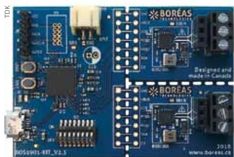
Figur 7. TDK:s PowerHap-utvärderingssats Z63000Z2910Z1Z44 använder Boréas piezoelektriska haptiska drivkretsar och uppfyller USB-ljudprotokollet, viktet förklarar konfigurationen.
