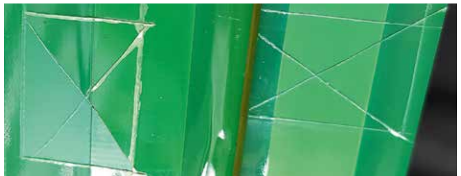
Avskalning av skyddslack till vänster efter rits- och tejpprov. God vidhäftning till höger.
