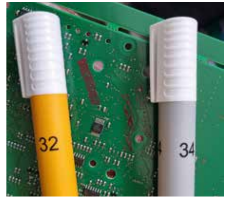
Exempel på speciella Dyne-pennor som använts i testerna.
