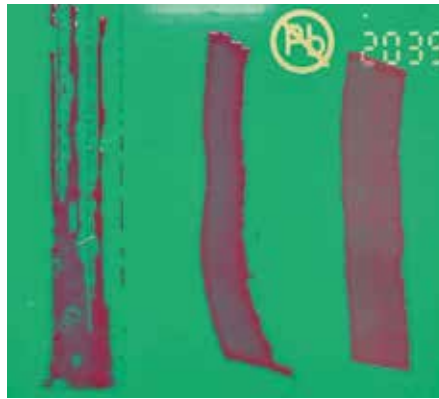
Lödmasken har ett godkänt Dyne-värde på cirka 34 mN/m, medan Dyne 38 är underkänt.
