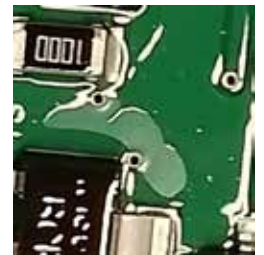
Exempel på dålig vätning eller avvätning av skyddslack.
