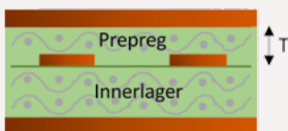
Figur 5. Ett gles ledarmönster ger ett tunnare prepreg efter pressning.
