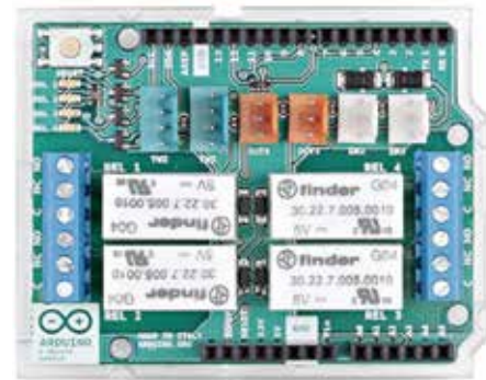
Bild 3. Arduino 4 Relays Shield ger möjlighet att driva högre belastningar än de digitala utgångarna kan leverera.
