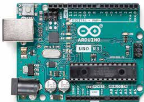
Bild 1. Styrkortet Arduino UNO R3. Notera stiftlistsockeln för UNO-sköldar.
