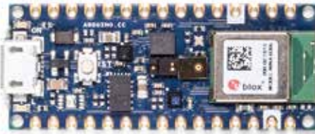
Bild 4. Arduino Nano 33 BLE Sense kan använda TinyML-maskininlärningsplattformen Edge Impulse.
