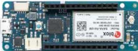
Bild 5. Arduino MKR NB 1500 kopplar upp sig via LTE Cat 1 M1/NB1.
