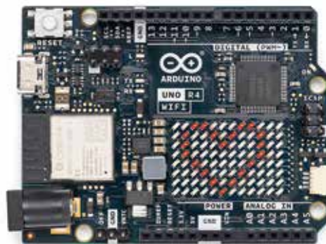
Bild 2. Kortdatorn Arduino UNO R4 Wi-Fi baseras på Renesas mikrokontroller RA4M1.
