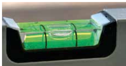
Ett traditionellt vattenpass som används för att visuellt bestämma lutningen.
