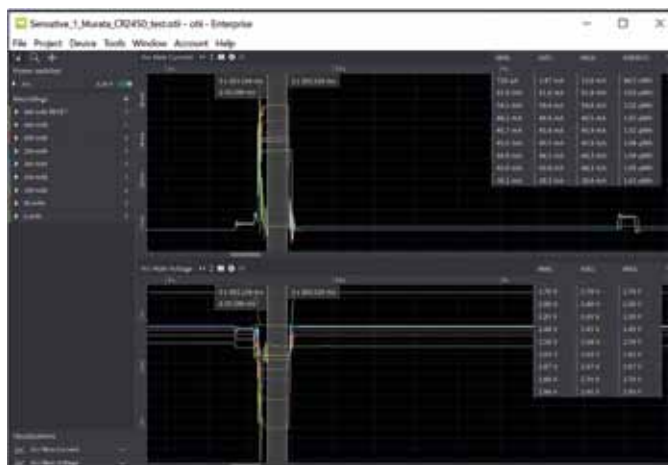
Figur 9. CR2450R från Murata, emulerad av Otii på Sensative LoRa Strips.
