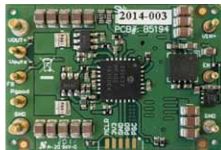
Figur 2. Referenskonstruktionen EPC9143 tillsammans med DSP-styrenhet.
