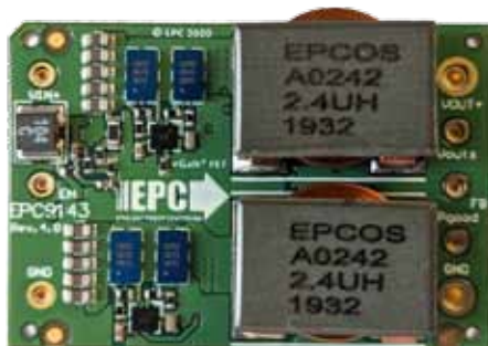
Figur 2. Referenskonstruktionen EPC9143 tillsammans med DSP-styrenhet.
