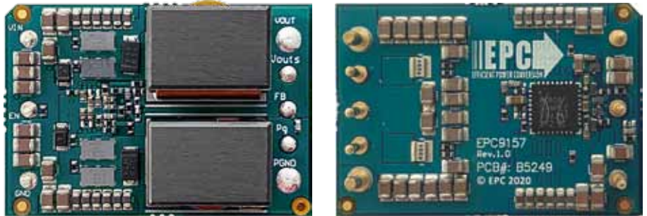
Figur 4. EPC9157 EVB med ISL81806 och fyra GaN-FET, endast analog styrning.
