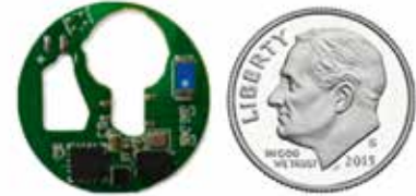
Bild 3. Referensdesignen inkluderar en analog ingångskrets (AFE) utvecklad av Xmoore och en systemkrets med Bluetooth från Renesas. Systemet drivs av ett standardbatteri på 1,5V och är inte större än 18 kvadratmillimeter, lika stor som ett amerikanskt 10-centsmynt, en dime.
