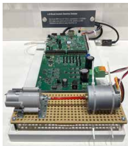
Bild 6. Att prediktera motorfel med CM85 – en demonstration. Med samma CNN-modell hade CM85 5,39 gånger högre prestanda än CM7. För en FFT i fixpunktstal var den 3 gånger högre och för FFT i flyttal 2,07 gånger.
