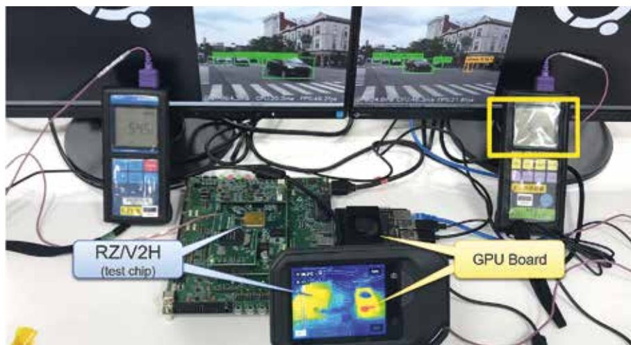
Bild 6. Jämförelse av värmeutveckling mellan ett fläktlöst RZ/V2H-kort och en GPU med fläkt.
