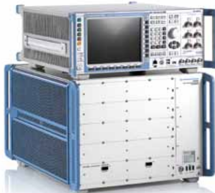
CMX500 är en radiokommunikationstestare för 5G NR både på millimetervågsområdet och för lägre frekvenser upp till 6 GHz.
