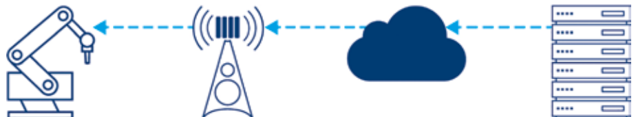
Envägsfördröjning mäts som tiden det tar för signalen att gå från sändare till mottagare medan fördröjningen fram-och-tillbaka även inkluderar tiden det tar för mottagaren att processa meddelandet och skicka tillbaka svaret.
