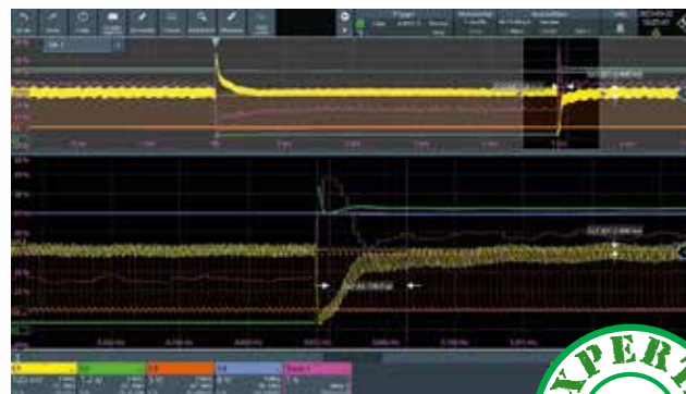
Figur 3. Konfiguration för lasttransienter hos en step-down-omvandlare.
