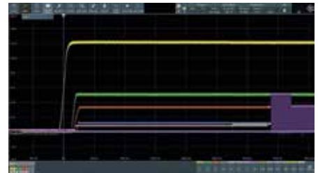
Strömsekvensmätningen visar tidsfördröjning mellan strömskenor.
