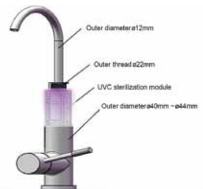
Bakteriefritt dricksvatten direkt från fontänen med Lextars steriliseringsmodul som drar mellan 10 och 30W och klarar ett vattenflöde på 2 till 12 liter per minut.
