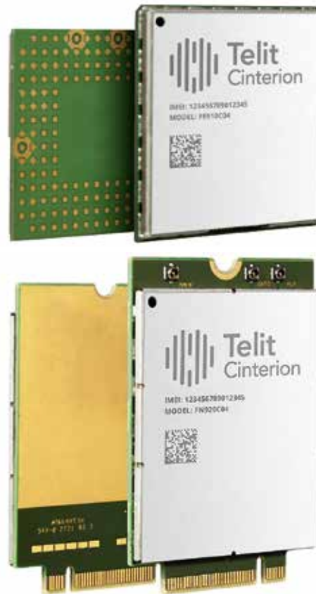
FE910C04 (övre) och FN920C04 (undre) ger 5G-uppkoppling med medelhög hastighet med Release 17. De är industriangepassade, robusta och lämpliga för global användning. Vidare har de förbättrad prestanda för upplänk, energisparfunktioner och kan byta till LTE Cat 4 när 5G saknas för bästa täckning.
