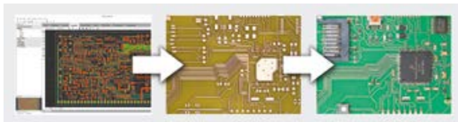
På bilden ovan CAD-data, det strukturerade mönsterkortet och den färdiga produkten.
