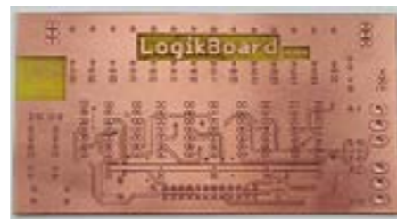
Ett dubbelsidigt FR4 med en laminattjocklek på 1,55 mm och 5 µm koppar plus 13 µm kopparplätning vilket totalt blir 18 µm. Med en Protolaser H4 är tidsåtgången 22,42 minuter totalt. Inklusivt galvanisk genomplätning ökar det till 172,41 minuter. Mönsterkortet är 60,96 x 120,65 mm och bearbetats med laser för strukturering och mekanisk för borrar och fräsarbeten.
