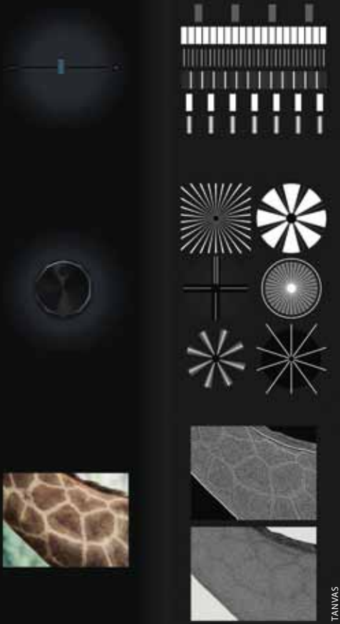
Bild 3. Designern skapar bilder och TanvasTouch-verktygen genererar motsvarande programvarudefinierade ythaptik.
