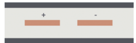
Figur 4. Motsvarigheten till partvinnande ledare i flexkort.
