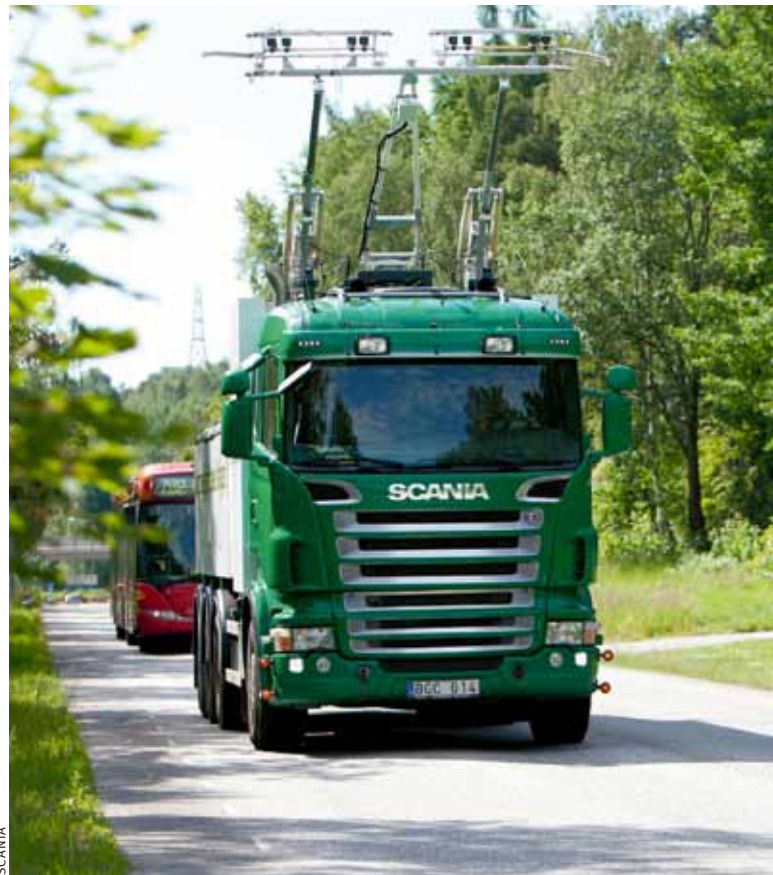
Scania är med i två utvecklingsprojekt för elektrifiering av vägar – ett tillsammans med tyska Siemens om luftledningar utefter vägarna och strömavtagare på lastbilens tak och ett tillsammans med kanadensiska Bombardier om induktiv laddning av lastbilens eller bussens batterier från strömskenor under vägbanan.
