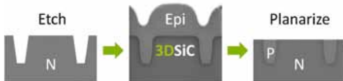
Ascatron etsar ut strukturer för att sedan odla in dopat material med epitaxi, medan andra driver in dopämnen med jonimplantering.
