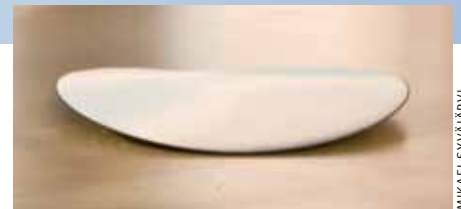
Kubisk kiselkarbid som framställs på kisel innehåller en mängd defekter som till och med kan ses med blotta ögat, eller så kan en skiva böja sig av spänningarna.
