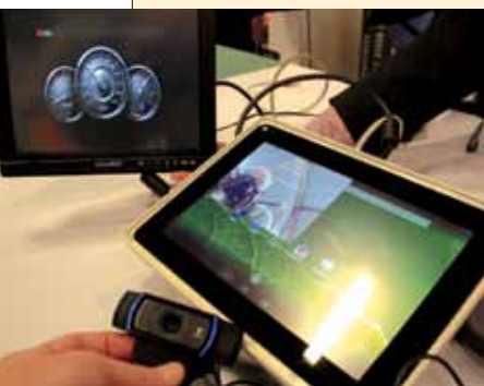
Green Hills Software kör Android, backkamera och instrumentkluster på en och samma Cortex A15-dubbelkärna – och visar därmed alla trender i en och samma demo.
