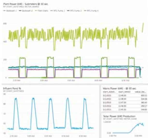
Data från ett reningsverks tusentals sensorer bearbetas i Azure och spottas ut i ett snyggt gränssnitt kallat Azure Power BI.
