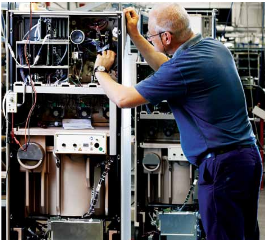
En tekniker på Sanmina i Örnsköldsvik monterar elektromekaniska och elektroniska moduler till blodsepareringsutrustning.
