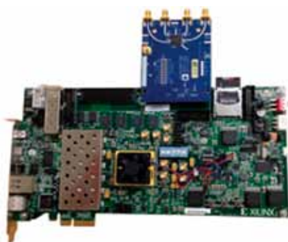
Här visas ett utvecklingskit med Analog Devices modul AD-FMCOMMS2-EBZ (blått kort i mitten) med RF-transceivern AD9361 ombord.
