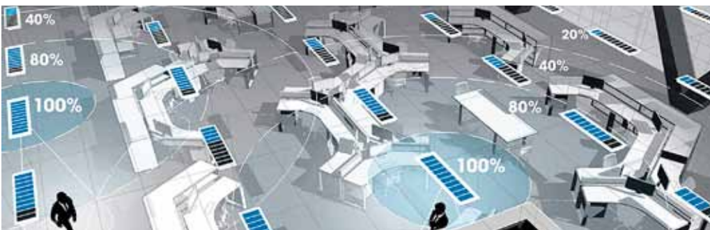
Maxljus endast där folk befinner sig demonstrerar hur smart ljusstyrning gör LED ännu energisnålare.
