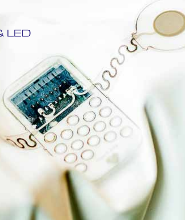
Heterogen integration av lysdioder i folie.
