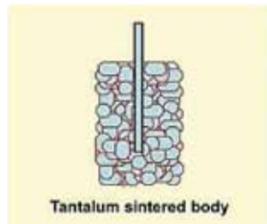
Till vänster en tantaltråd med pressat tantalpulver som därefter sintras för att pulvret skall sitta fast ordentligt. Bilden i mitten visar uppbyggnaden efter anodisering och applicering av katod, i detta fall mangandioxid. Bilden längst till höger visar slutligen uppbyggnaden av den färdiga tantalkondensatorn.
