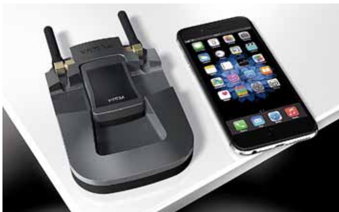
Basstationen till vänster är inte mycket större än en mobiltelefon. Den fungerar även som induktiv laddare när en tagg, likt på bilden, läggs ovanpå. Taggen är liten, men avancerad. Den innehåller Bluetooth LE-processorn CC2640 och radiokretsen CC1310, båda från Texas Instruments. Som huvudprocessor används en Arm Cortex M3. Bluetooth används enbart vid installation för att få plug-and-play med mobilen. Till höger syns ett armband som taggen kan fästas på med hjälp av en hållare som snäpps fast.
