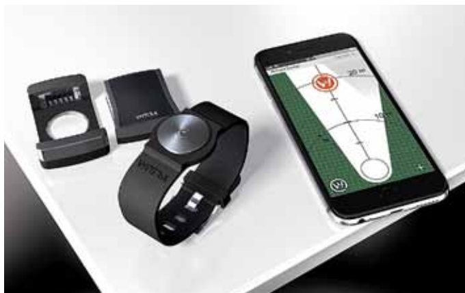
Basstationen till vänster är inte mycket större än en mobiltelefon. Den fungerar även som induktiv laddare när en tagg, likt på bilden, läggs ovanpå. Taggen är liten, men avancerad. Den innehåller Bluetooth LE-processorn CC2640 och radiokretsen CC1310, båda från Texas Instruments. Som huvudprocessor används en Arm Cortex M3. Bluetooth används enbart vid installation för att få plug-and-play med mobilen. Till höger syns ett armband som taggen kan fästas på med hjälp av en hållare som snäpps fast.
