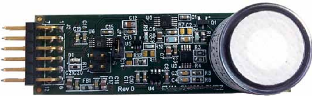
Analog Devices CN0357, en lågbrusig gasdetektor som drivs med en enda matningsspänning. Genom att använda elektromekaniska sensor med programmerbar förstärkning går det snabbt att ta fram prototyper.
