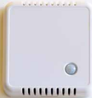
Inomhus-sensorn ERS mäter temp, luftfukt, koldioxid, ljus och rörelse.
