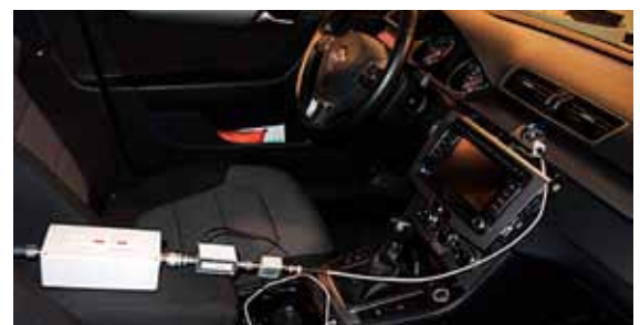
Uppkopplingen inne i bilen med filter som reducerar störningar via skärmen och impedansomvandlare kopplad till antennerna som är integrerade i bilrutorna. Omvandlaren är också kopplad till mätmottagaren som är placerad utanför bilen. Nästan alla rutor i bilen har en specifik antennfunktion: AM, FM, GPS, Bluetooth, wlan, etc.
