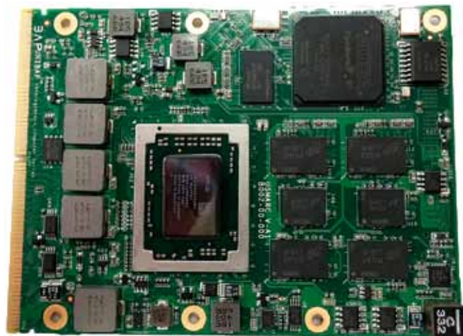
Minne, cpu, grafik, fpga, utvecklingsverktyg – allt är starkare i generation tre av Unibaps heterogena beräkningskort.
