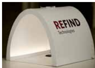
Desktop Grader är en liten sorteringsenhet med en ljusstunnel för jämn belysning och en smartmobil med kamera som kör mjukvaran.
