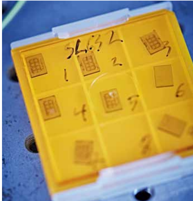
Den lilla asken rymmer nio chip med blå emitterande lysdioder gjorda av material baserat på galliumnitrid (GaN).
