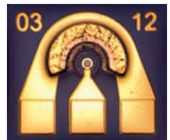
En ytemitterande laser för en fiber med en kärna.
