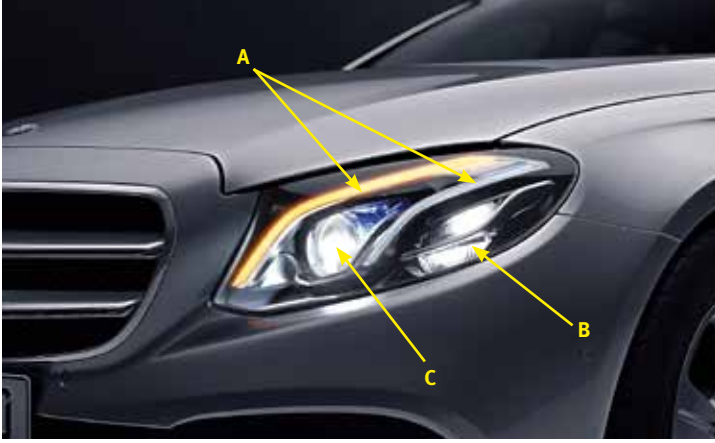
Frambelysning Mercedes. Varselljus som också används som blinkers (A). Rörlig halv-ljusmodul (B). Helljusmodul baserad på lysdiodsmatris (C).
