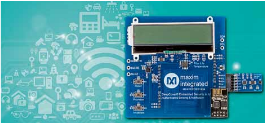
Figur 2. Den här ARM mbed-baserade IoT-referenskonstruktionen kan användas för att autentisera IoT-noder, skydda industriella tillämpningar från förfalskning, spåra produktlivslängd, leverera smarta meddelanden och invalidera osäkra industriella sensornoder.
