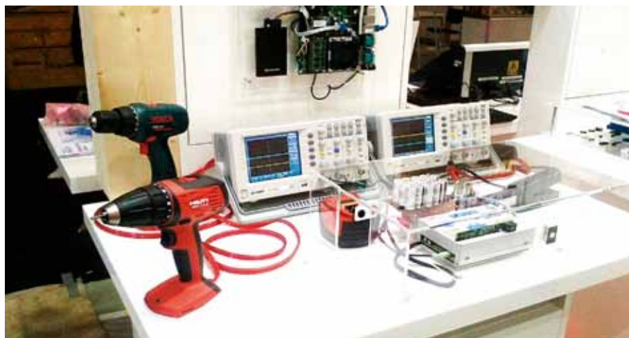
Praktisk mätuppställning med demonstratorn i form av en batteridrivna skruvdragare.
