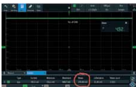
Figur 1. Mätning av DC-spänning utan optimering av inställningarna på oscilloskopet.
