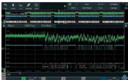
Figur 4. Samtidig presentation av DC-kraftmatningen och Canbussen som digital och avkodad signal.
