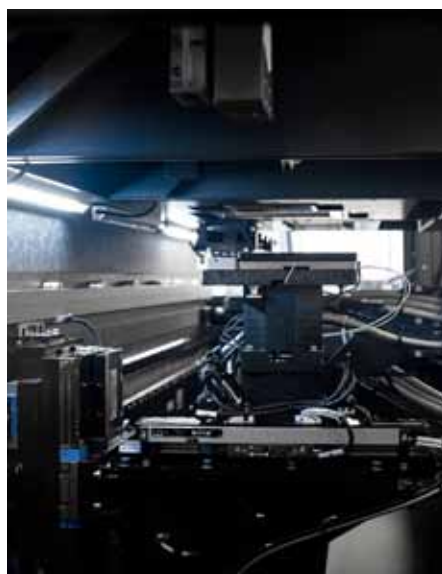
Maskinen innehåller olika moduler för tillverkning av mönsterkortet, dispensering, komponentmontering och test.
