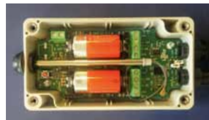
En batteridrivna styr- och kommunikationsenhet, utvecklad av Talkpool, som övervakar vårt dagvatten. Monterad i avloppsbrunnen mäter den vattennivån och skickar data via ett Loranät till Internet.
