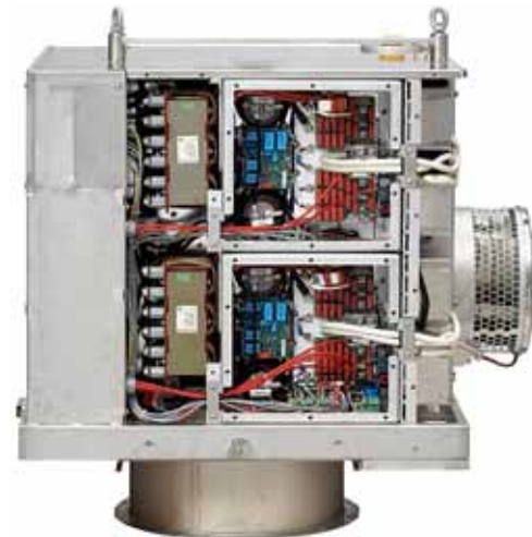
Ett kraftaggregat på toppen av det elektrostatiska filter som syns i illustrationen på föregående sida. På bilden till höger går det att få en skymt av elektroniken i ett kraftaggregat.
