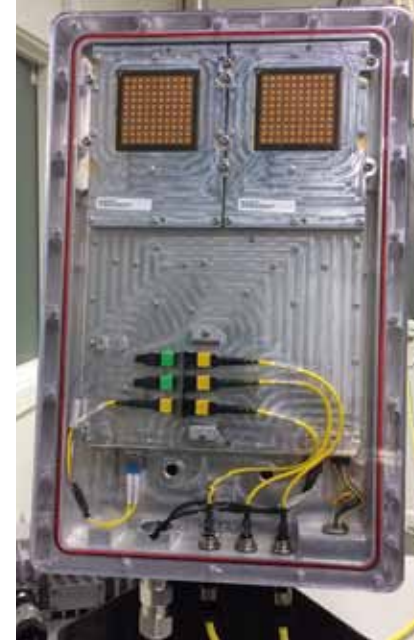
En radioenhet, kallad Micro AIR (Antenna Integrated Radio), med två antennmoduler bredvid varandra.
