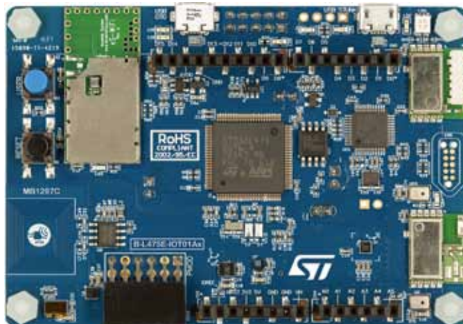
Amazon FreeRTOS stöds på ST:s STM32L4-utvecklingskort B-L475E-IOT01A Discovery kit for IoT node.
