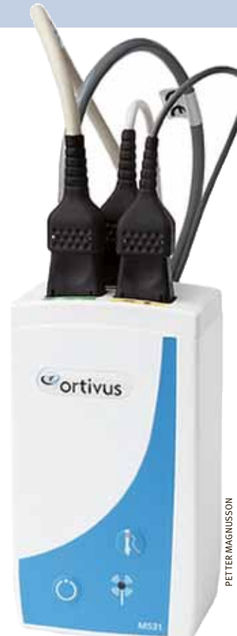
Ortivus mätenhet M-531 kan mäta EKG, syremättnad i blodet, andningsfrekvens, icke-invasivt blodtryck samt koldioxidhalten i utandningsluften.
