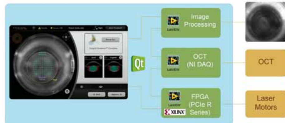
Optimedica har utvecklat en maskin för ögonkirurgi med laser. Med hjälp av en kamera och Labview kan man hela tiden följa positionen på patientens öga. Informationen används för mycket exakt styrning av lasern via algoritmer som implementerats i en FPGA.
