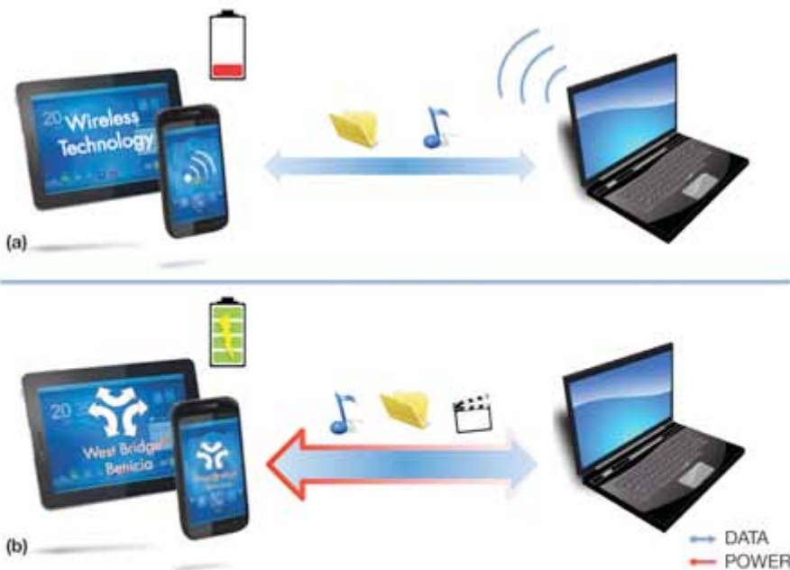
Figur 6. Trådlös teknik West Bridge Benicia. Om digitalt innehåll överförs trådlöst mellan mobila enheter och datorer samtidigt kommer enhetens batteri att urladdas om den inte är ansluten till en laddare i ett vägguttag eller en dator via USB (a). USB 3.0 har många anslutningsmöjligheter, hög bandbredd, och batteriladdningsmöjligheter som gör att systemet enkelt kan användas tillsammans med Wi-Fi på mobila enheter under överskådlig framtid (b).
