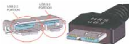
Figur 1. I mikrokontakten för USB 3.0 går USB 3.0-ledningarna längs med USB 2.0-anslutningen. Den här anslutningskontakten har en större profil än en USB 2.0-kontakt, vilket innebär problem för tillverkare av mobilenheter.
