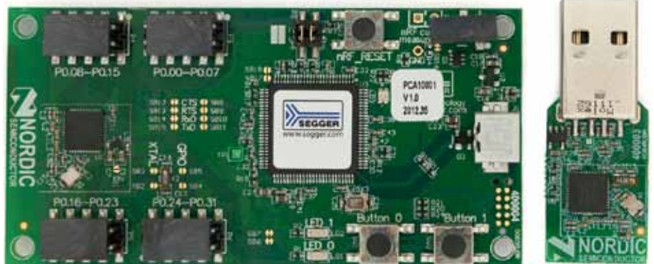
Med norska Nordic Semiconductors utvärderingspaket, baserat på systemkretsen nRF5, blir det enklare att utveckla trådlösa sensorsystem och andra produkter som kommunicerar på 2,4 GHz.
